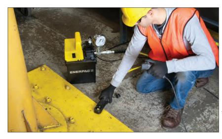
Esta bomba Submersa PED-1101B aciona, rápida e silenciosamente, o cortador de porcas Enerpac nesta aplicação de manutenção.
